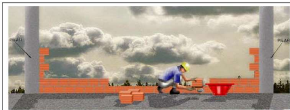
Assentamento de alvenaria 1
