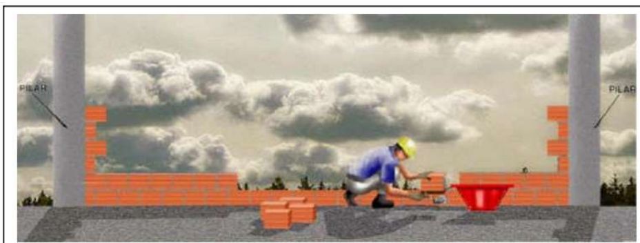
Assentamento de alvenaria 1
