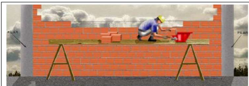
Assentamento de alvenaria 3
