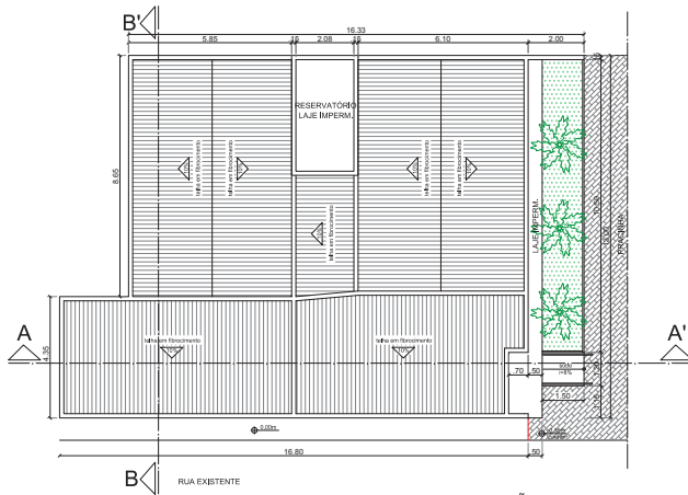
PLANTA DE LOCAÇÃO E COBERTA ESCALA 1/100
