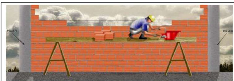
Assentamento de alvenaria 3
